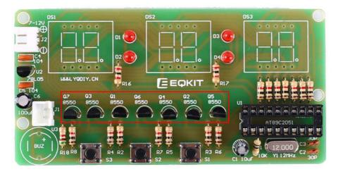
Step 17:Install 3pcs 4Bit Red Common Anode Digital Tube at DS1~DS3.
